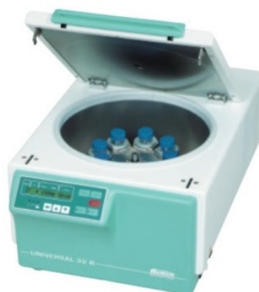
ภาพที่ 3 เครื่องปั่นเหวี่ยง (centrifuge)
